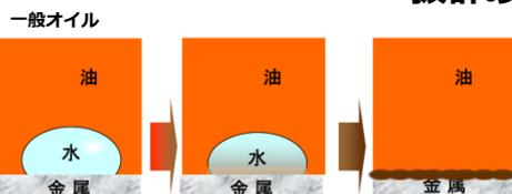
VpCIインヒビターの極性基が水分を金属からひきはがし、さらに防錆・保護します。
